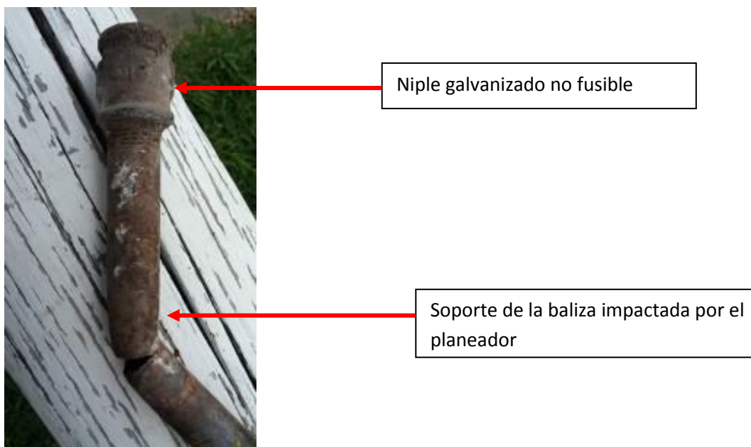
Figura 5. Baliza sin elemento fusible
