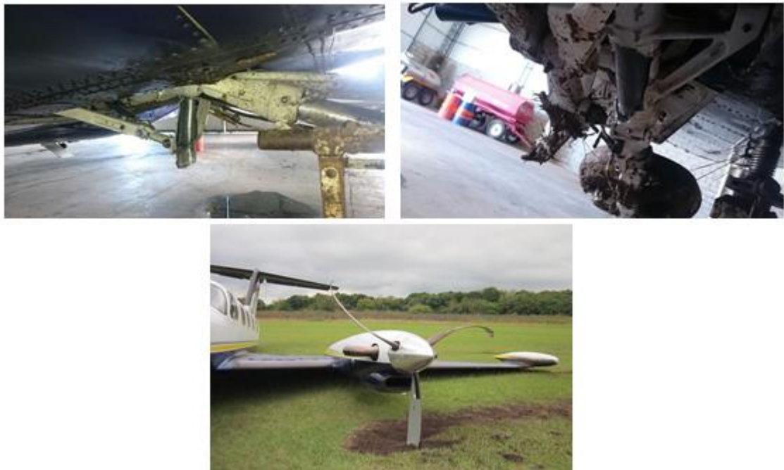
Figura 3 Vista general pata de tren principal izquierda y hélice izquierda
