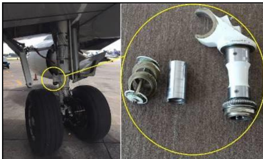
Figura 2. Daños en el tren de aterrizaje
