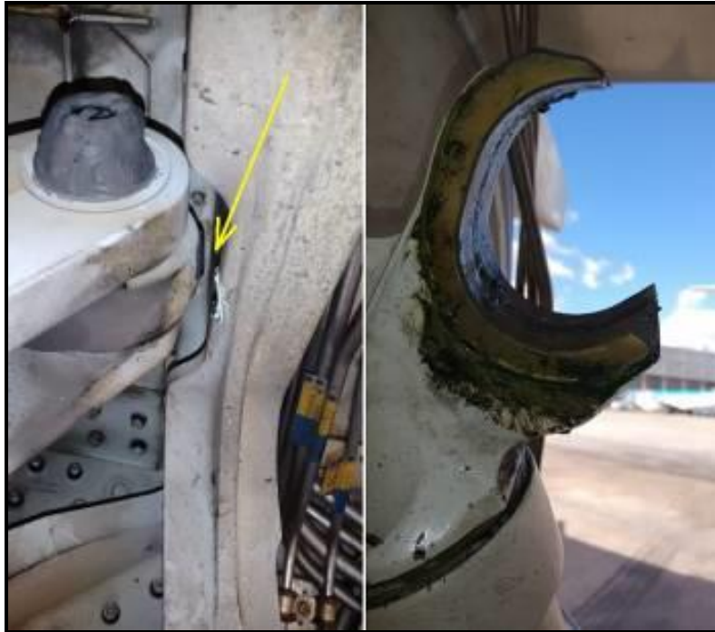
Figura 8. Imagen de la pieza dañada y marcas en la parte superior del tren de aterrizaje principal
