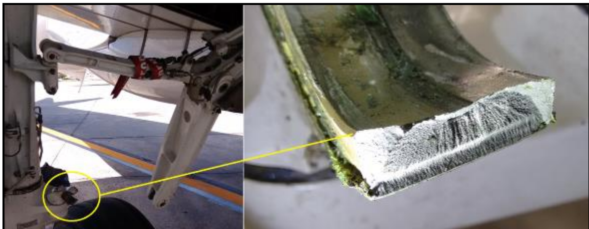
Figura 9. Imagen de la pieza dañada, superficie de fractura
