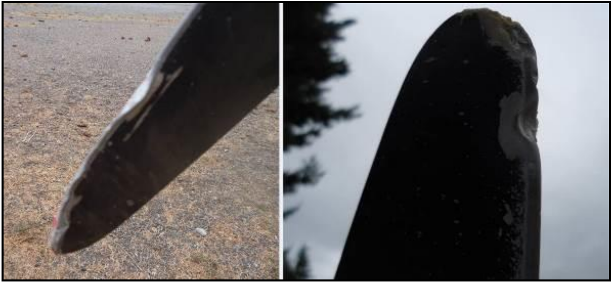
Fig. 8: Daños en la pala.
