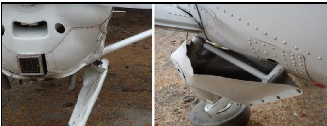
Fig. 7: Daños sobre el tren principal izquierdo.
