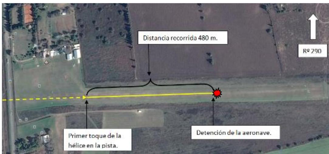
Figura 4. Vista aérea del aeródromo de Alta Gracia
