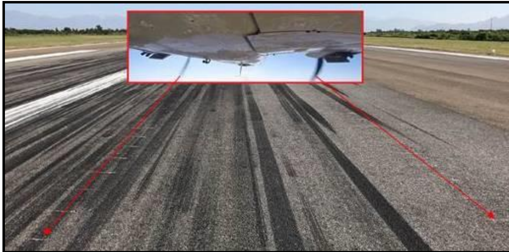
Figura 10. Inicio de las marcas a 620 metros de cabecera 34
