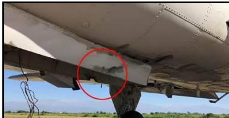
Figura 13. Daños en las tapas del tren de nariz
