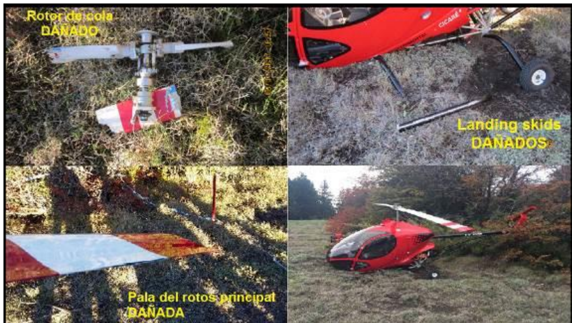
Figura 1. Vista de diferentes partes dañadas del helicóptero
