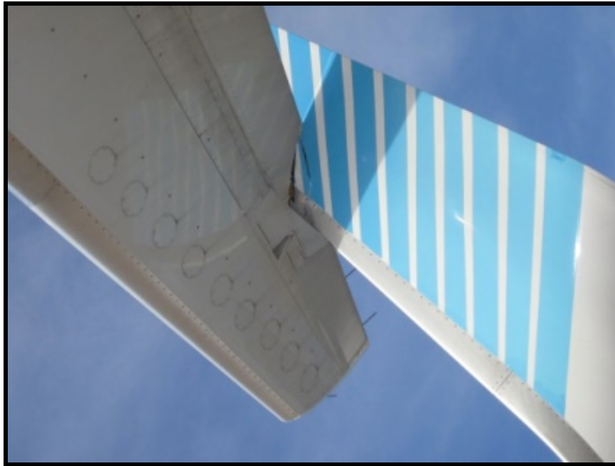
Fig.14: Detalle del impacto producto de la colisión.
