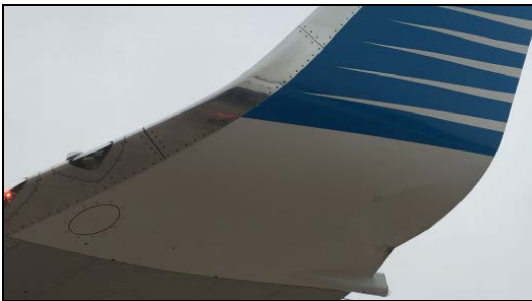
Fig.2: Daño en el Wing Let LV-FWS
