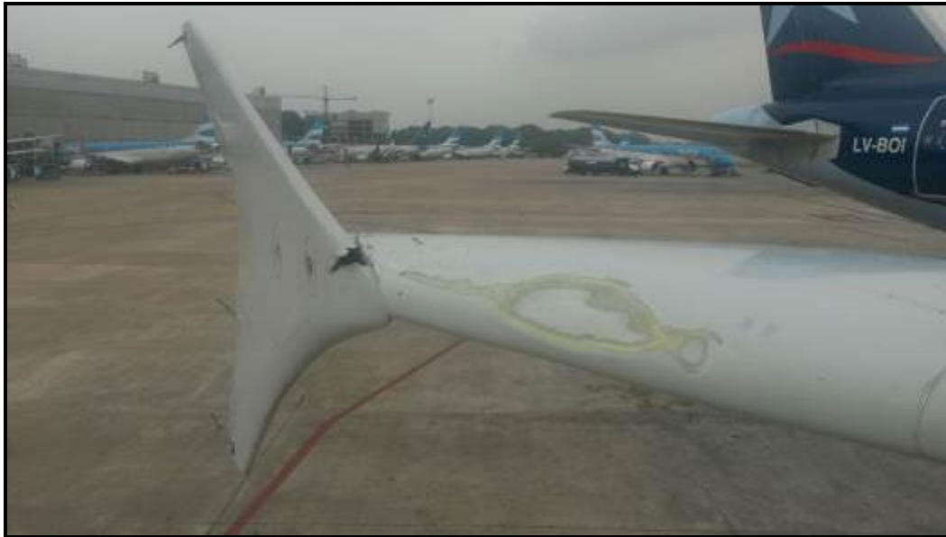
Fig. 1: Daño en Wing Let LV-BOI
