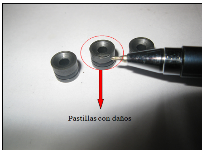
Figura 4. Pastillas con daños
