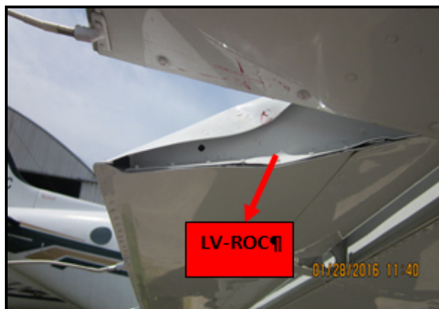
Figura 1. Daños en alerón
