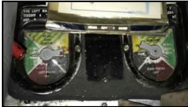
Figura 7. Imagen de llaves selectoras de tanques de combustible
