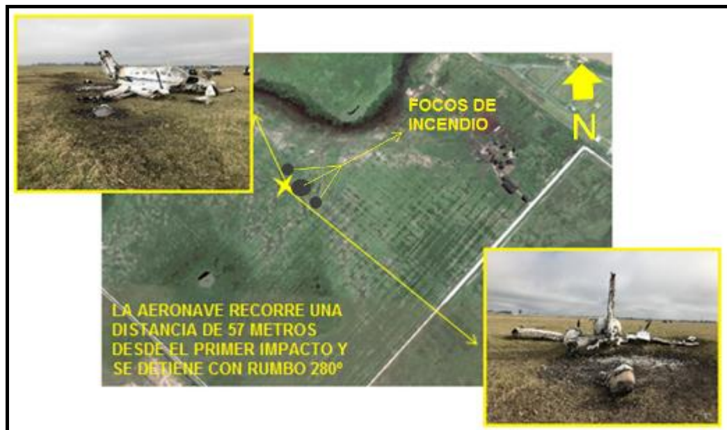
Figura 5. Imagen de la aeronave accidentada y marcas dejadas en el terreno
