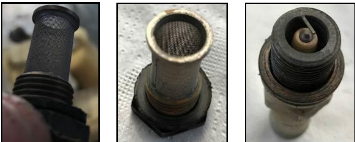
Figura 10. Filtro de unidad de control de combustible y bujía de motor derecho
