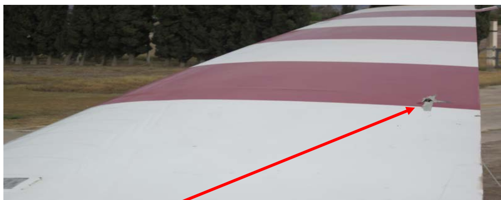
Pala N°1 del rotor principal agujero de 3 cm de diametro
