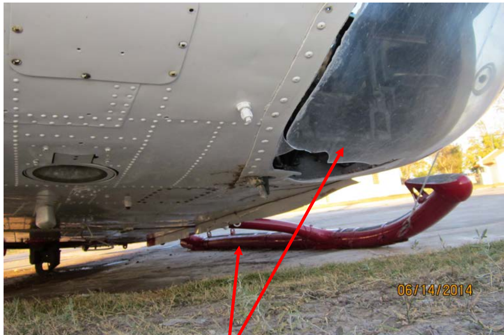
Rotura del parabrisas inferior izquierdo, skis y tubos cruzados.
