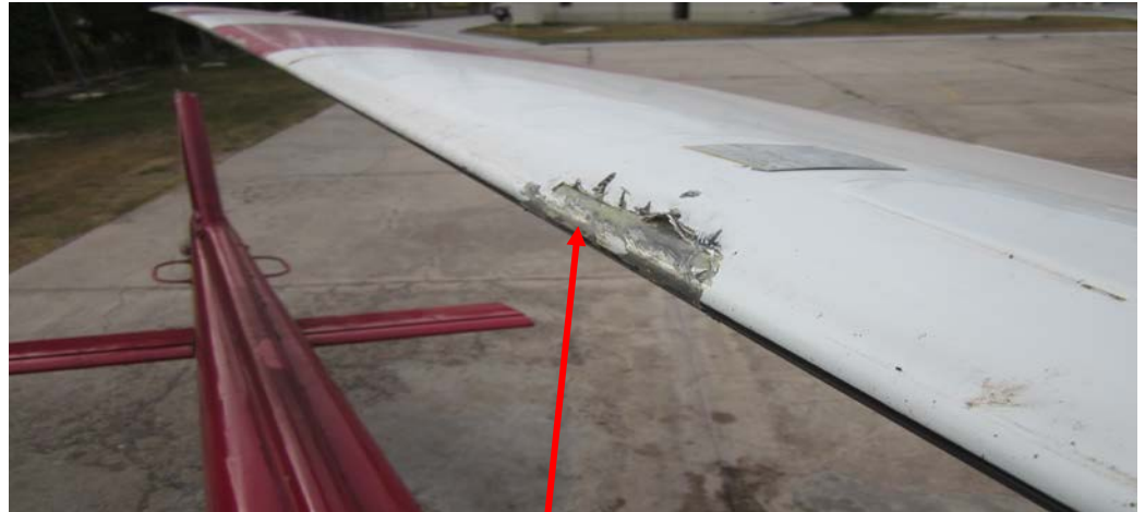
Pala N°2 del rotor principal con melladura en borde de ataque
