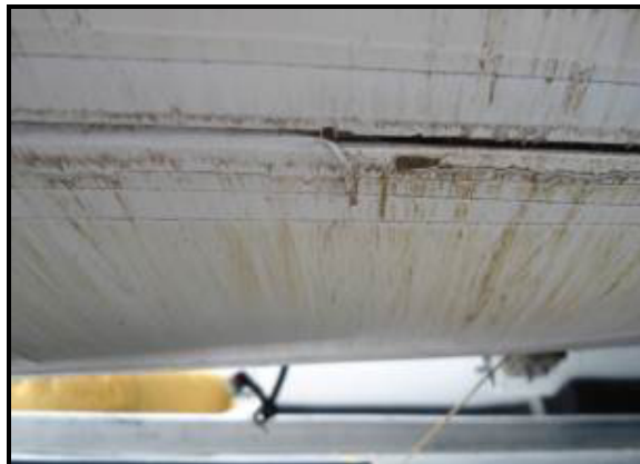
Fig. 10: Marcas dejadas sobre las tapas del tren de aterrizaje.
