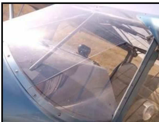
Fig. 1. Rotura del parabrisas de la aeronave
