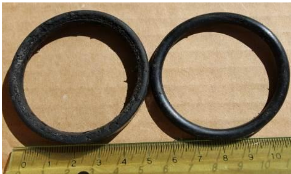
Fig. 12: Vista general de los sellos deteriorados.
