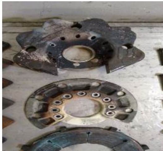
Fig. 4: Vista del conjunto de freno con indicios de sobrecalentamiento.
