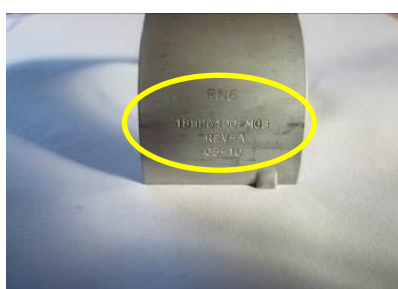
Fig. 7 - Cojinete original donde se observa la identificación
