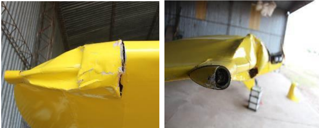
Figura 3. Daños producidos en la aeronave
