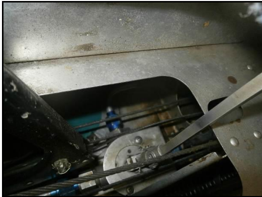
Figura 3. Detalle de la llave de corte de combustible.
