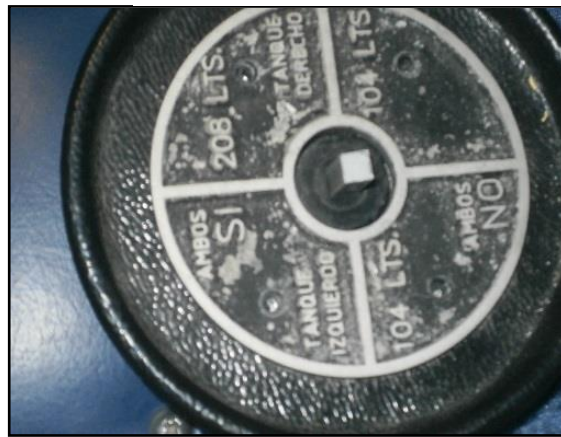
Figura 4. Vista de la llave de corte de combustible con las posiciones que se pueden seleccionar.
