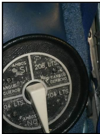
Figura 4. Vista de la llave de corte de combustible con las posiciones que se pueden seleccionar.
