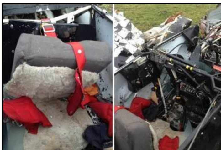
Figura 9. Habitáculo sin deformaciones
