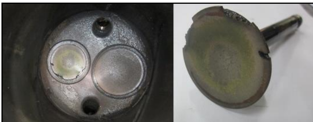
Figura 14. Daños en la válvula de escape del cilindro N° 3
