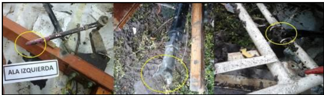
Figura 11. Comandos de alerón izquierdo y timón de profundidad
