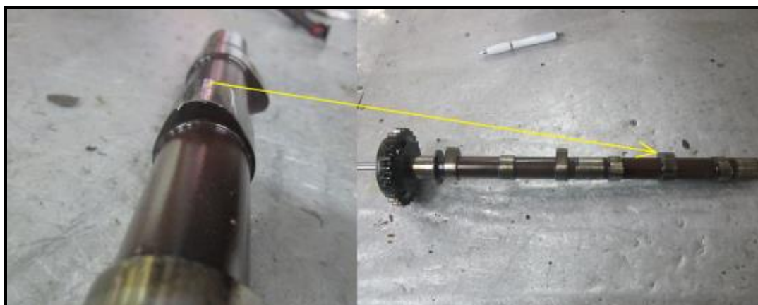
Figura 15. Desgaste del árbol de levas de los cilindros N° 1 y N° 2
