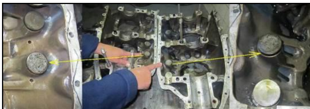
Figura 16. Desgaste sobre los botadores de admisión de los cilindros N° 1 y N° 2
