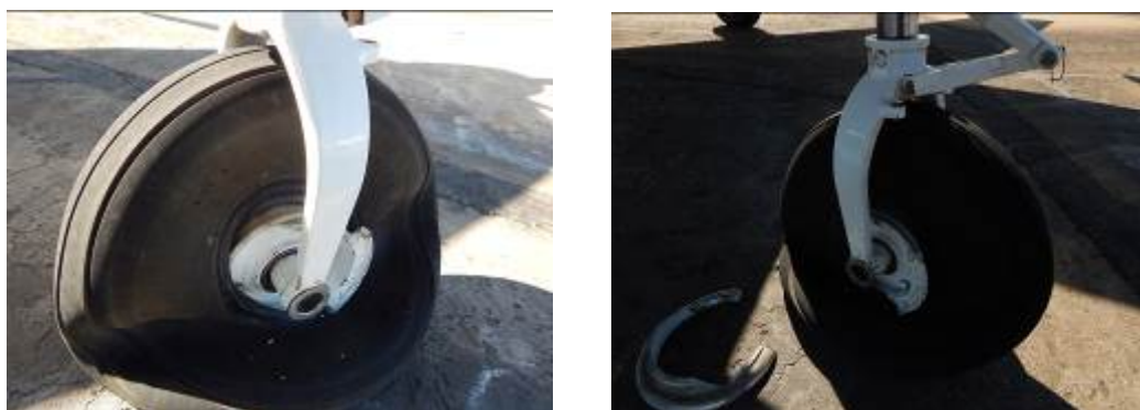
Fig. N° 2: Vista de la rueda de nariz luego de la detención de la aeronave.
