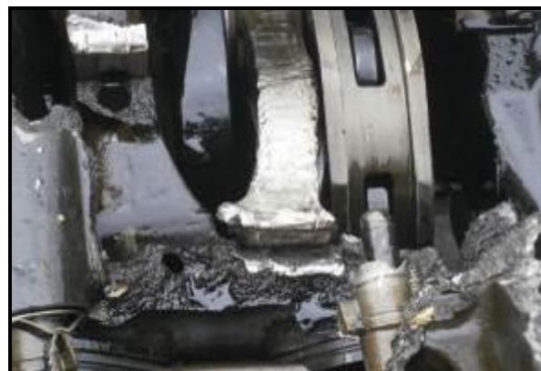
Fig. 5: Rotura producida por la biela del cilindro N° 6 (biela rota en el ojo y doblada).
