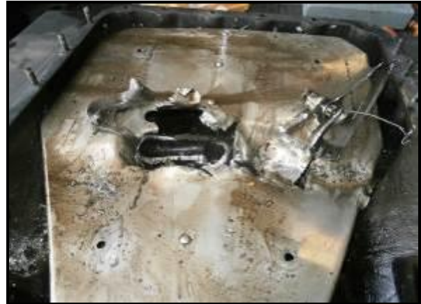
Fig. 9: Chapa con roturas del depósito de aceite que fueron agujereadas por la biela.
