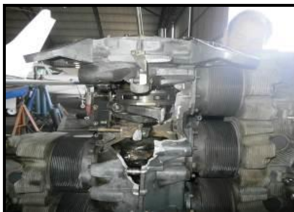
Fig. 3: Rotura producida por la biela del cilindro N° 5.
