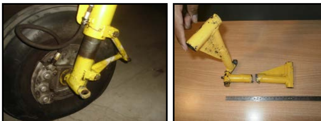
Fig. 1: Imagen del tren de aterrizaje derecho (Reparado) y de la tijera rota.
