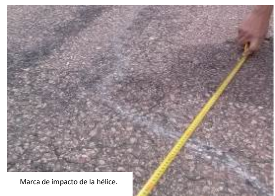
Fig. 3: Imágenes de las marcas dejada en la pista por la aeronave.
