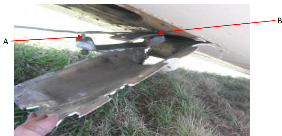
Bulones del soporte (clamp): (A) desprendido (B) deformado
