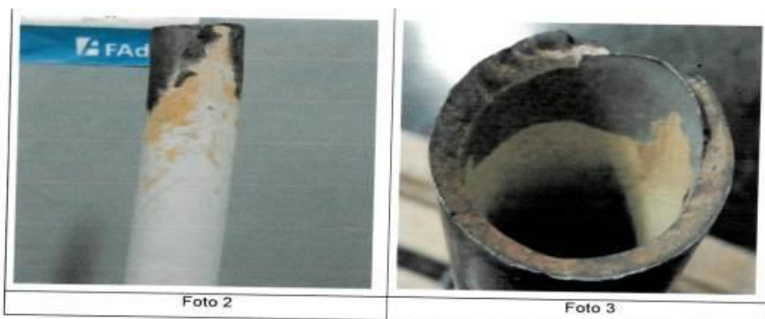
Fig. 3: Fractura del eje del rotor principal (mástil).
