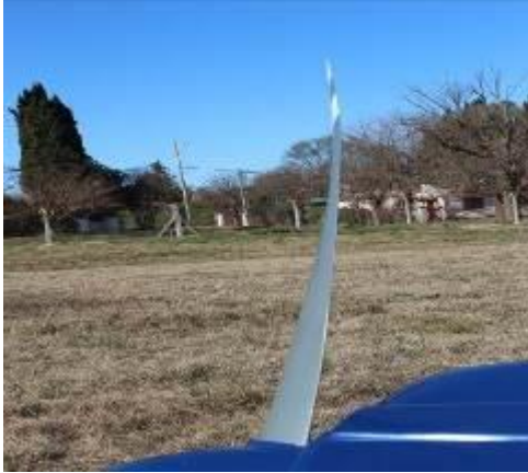
Vista general de los daños producidos en la aeronave
