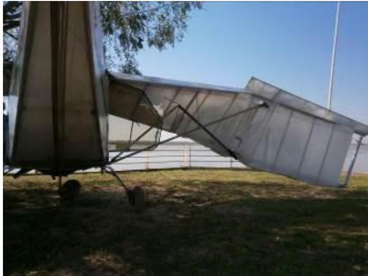
Imagen 3. Vista de la aeronave con detalle de los daños del ala derecha
