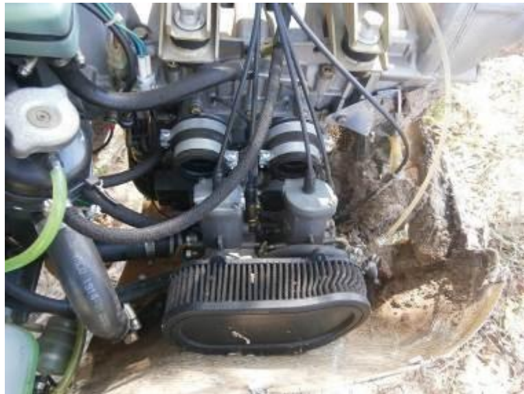
Imagen 4. Vista en detalle de la condición en la que se encontró a los carburadores separados del motor
