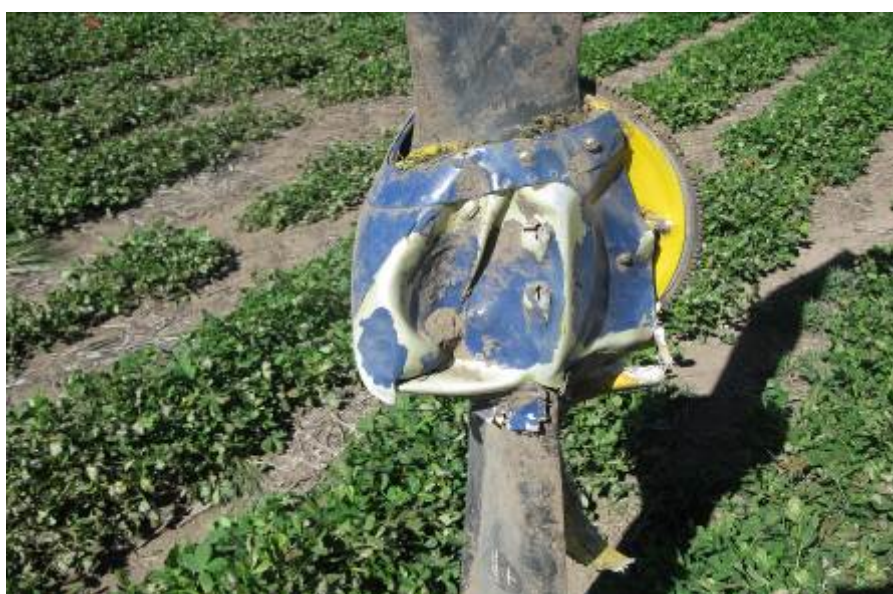
Fig. 3 – Restos de la hélice y su cono.
