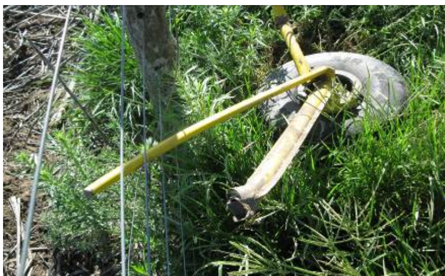
Fig. 2 – Vista del tren principal desprendido.
