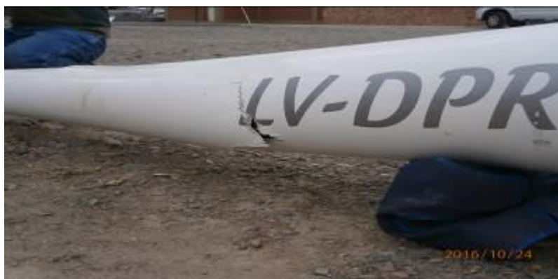
Figura 4 Rajadura transversal muy importante en la parte posterior del fuselaje
