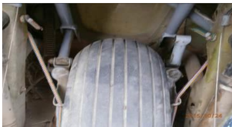
Figura 2. Biela del mecanismo de extensión y retracción del tren de aterrizaje, se muestra colapsada y curvada.
