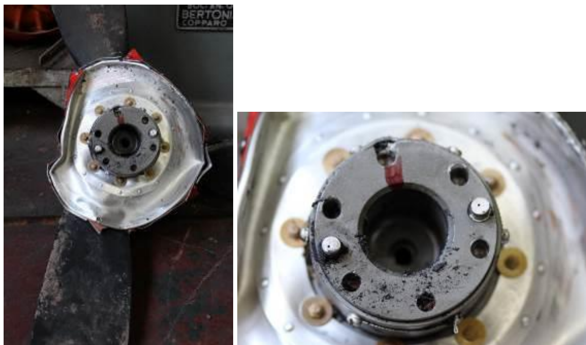
Figura 11. Daños observados en la zona de anclaje de la hélice
