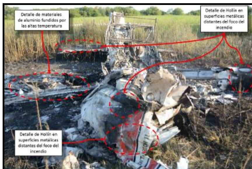
Figura 5. Imagen con detalles de hollín, fundición de material de aluminio y quemadura de pintura
