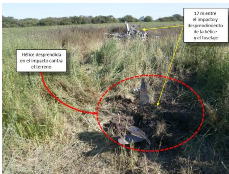
Figura 5. En el segundo impacto se desprendió la hélice, la cual se encontró a 17 metros del fuselaje
