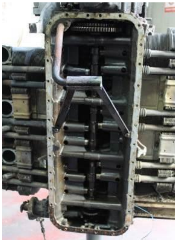
Figura 4. Vista del desarme del árbol de levas, botadores y trenes de ruedas dentadas
