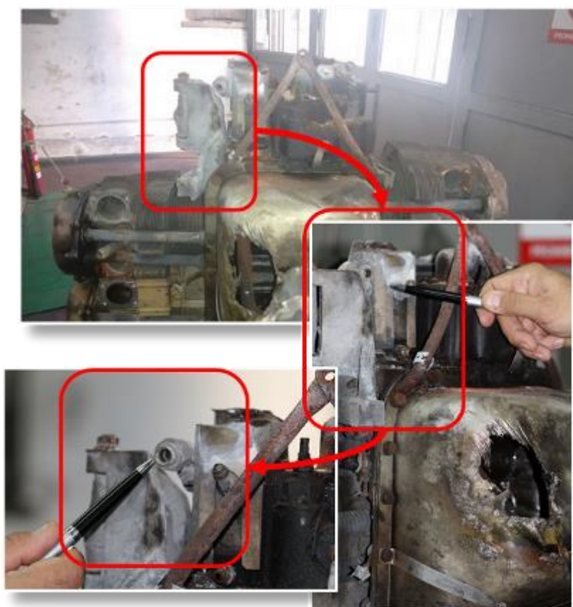
Figura 6. Imágenes del motor, con detalles del posible lugar donde se produjo el corte de la línea de combustible que llegó a la unidad de control de combustible e inició el fuego
