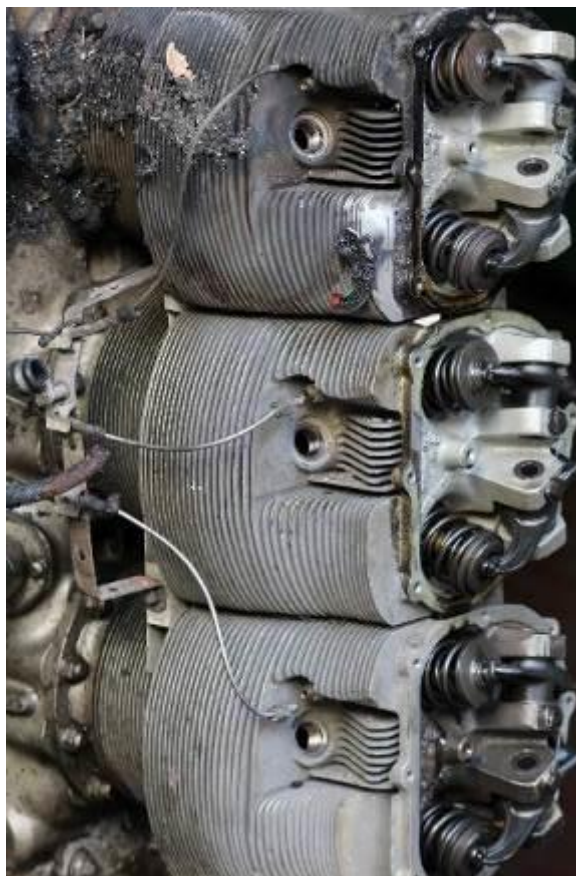
Figura 2. Desarme de cilindros, válvulas e inyectores de combustible
