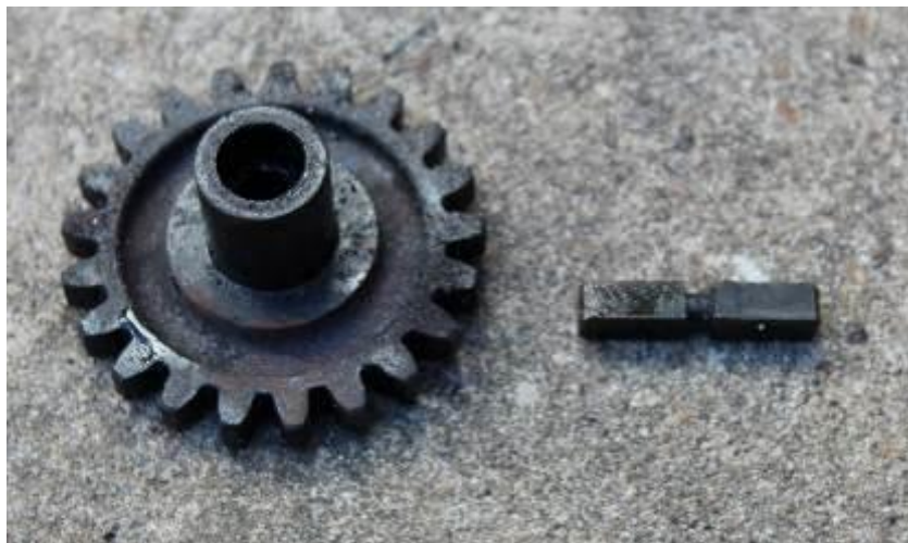
Figura 6. Rueda dentada y eje fusible de la bomba de combustible
