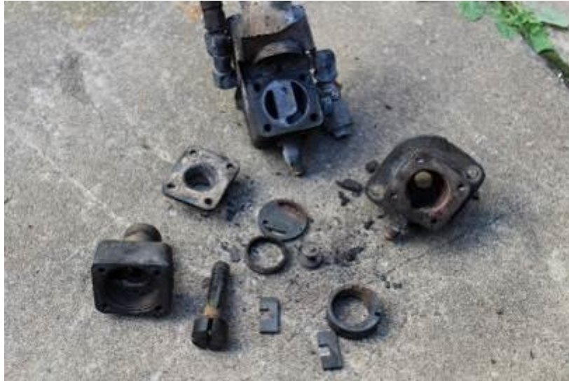
Figura 5. Desarme de la bomba de combustible
