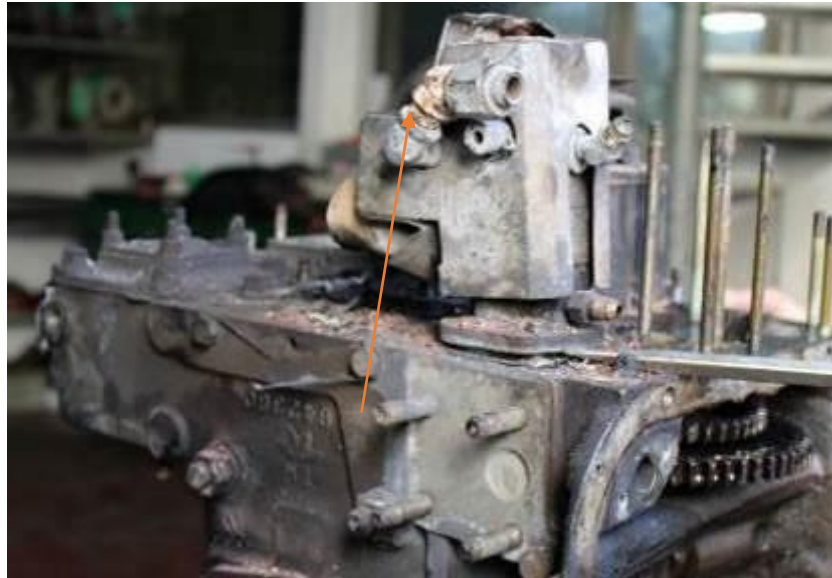
Figura 12. Zona de colapso e inicio del incendio
