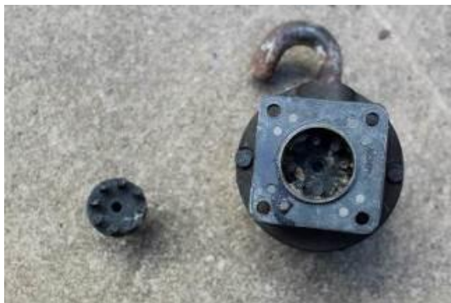
Figura 8. Vista del eje fusible de la bomba de vacío
