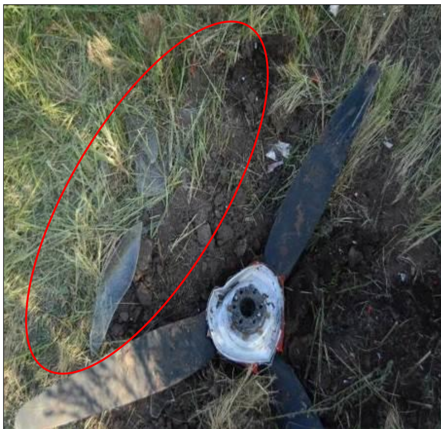
Figura 9. Imagen de restos de plexiglás junto a la hélice
