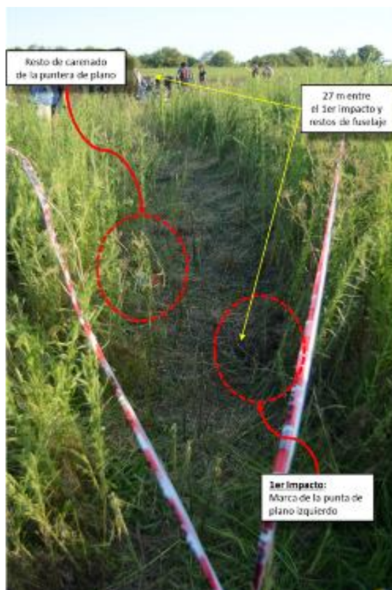
Figura 4. Imagen del lugar del primer impacto con las marcas y restos del carenado de puntera de plano
