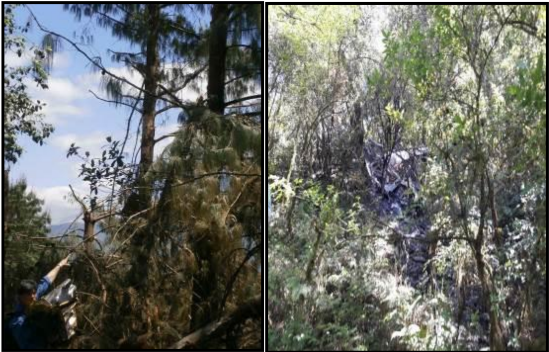
Figura 4. A la izquierda detalle del primer impacto contra los árboles y a la derecha restos de la aeronave debajo del lugar donde se produjo el primer impacto
