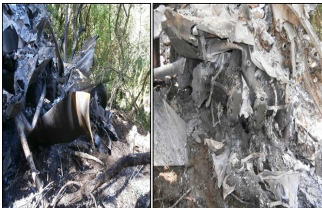
Figura 6. A la izquierda vista del motor y hélice destruidos. A la derecha restos del motor incendiado
