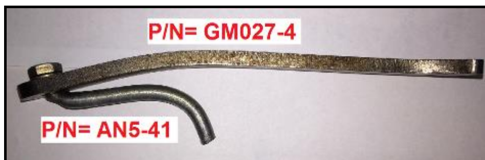
Figura 8. Deformación de la pieza P/N=GM027-4 y bulón P/N=AN5-41
