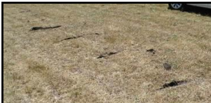
Figura 6. Marcas dejadas por la hélice en el terreno
