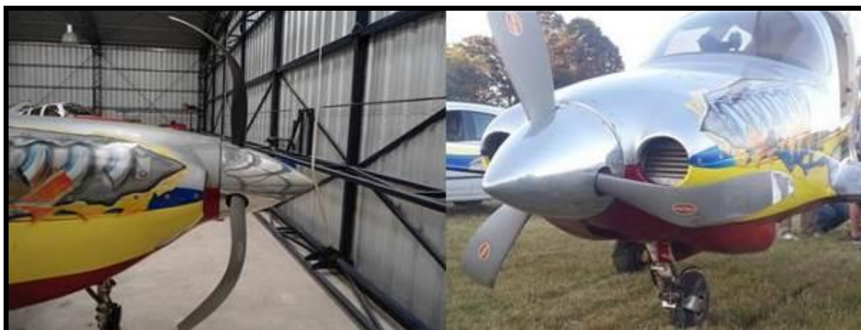
Figura 3. Vista de daños en la hélice
