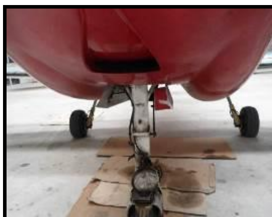
Figura 2. Daños tapas de tren de aterrizaje de nariz
