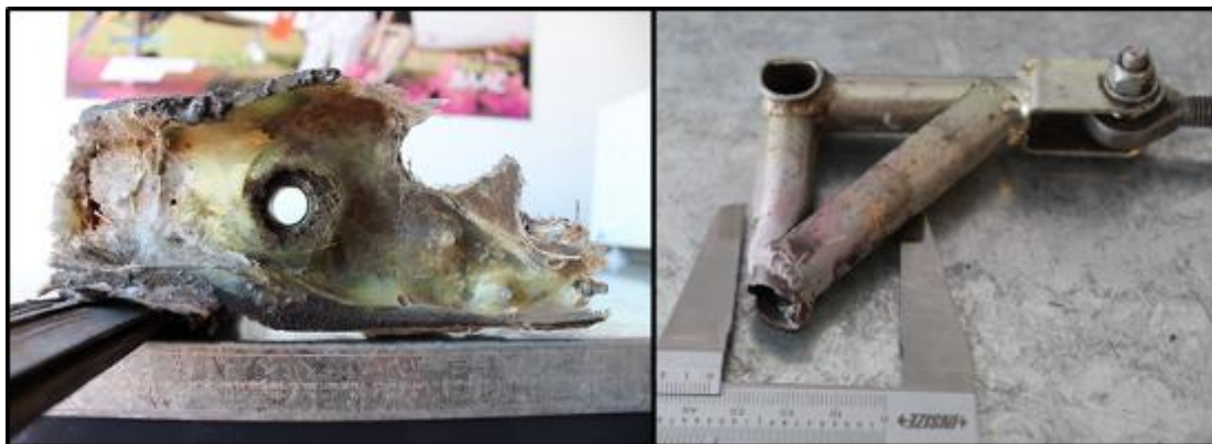
Figura 12. Costilla de raíz y brazo de accionamiento del freno del ala izquierda
