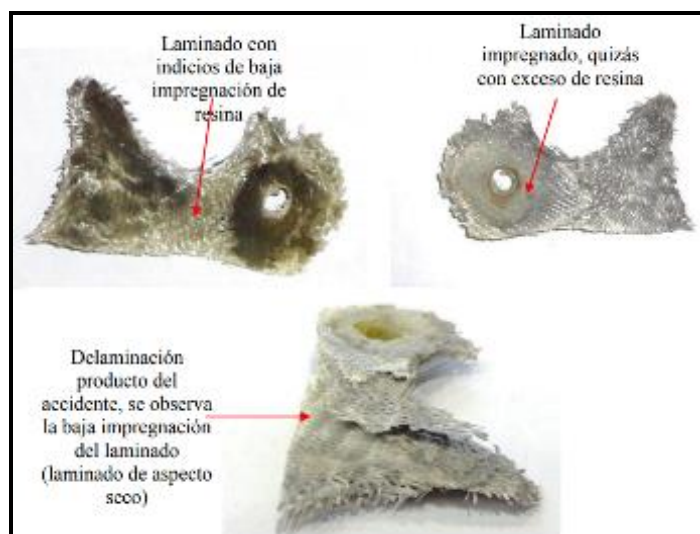
Figura 15. Detalle del laminado con baja impregnación
