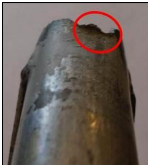
Figura 18. Punto de arrancamiento con doblez del material hacia arriba
