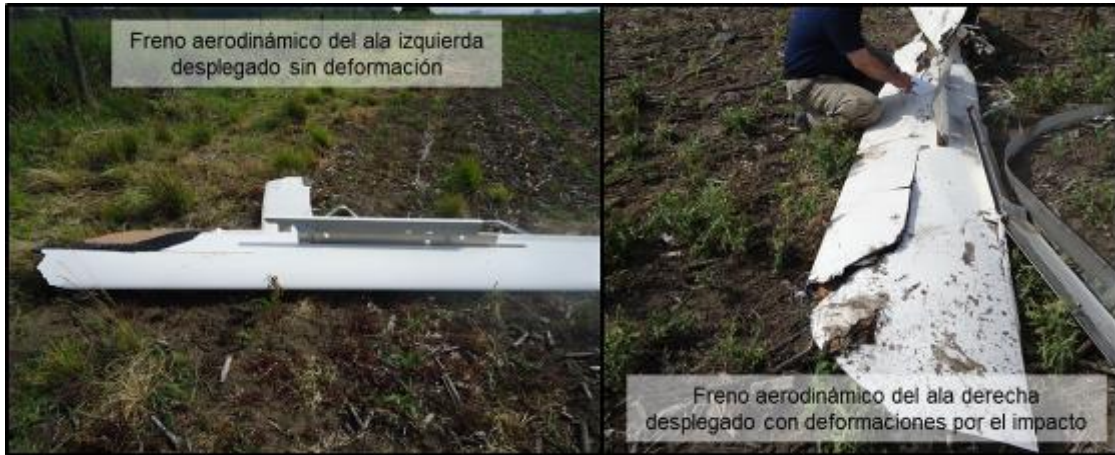
Figura 7. Estado de los frenos aerodinámicos posaccidente
