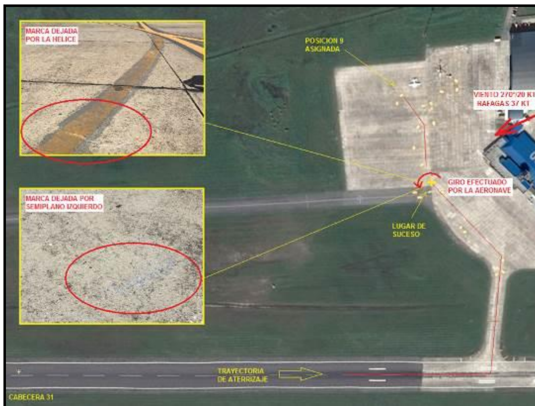
Figura 5. Descripción del suceso y marcas dejadas por la aeronave
