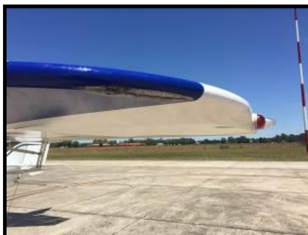
Figura 2. Daños en puntera de semiplano izquierdo
