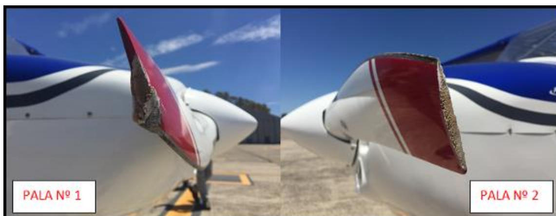
Figura 3. Vista de daños en la hélice
