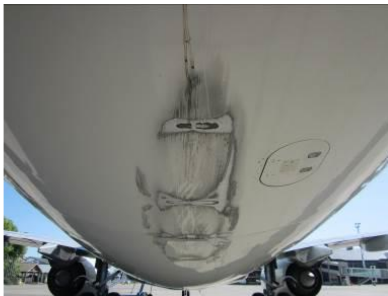
Figura 2. Daños en la parte inferior del fuselaje
