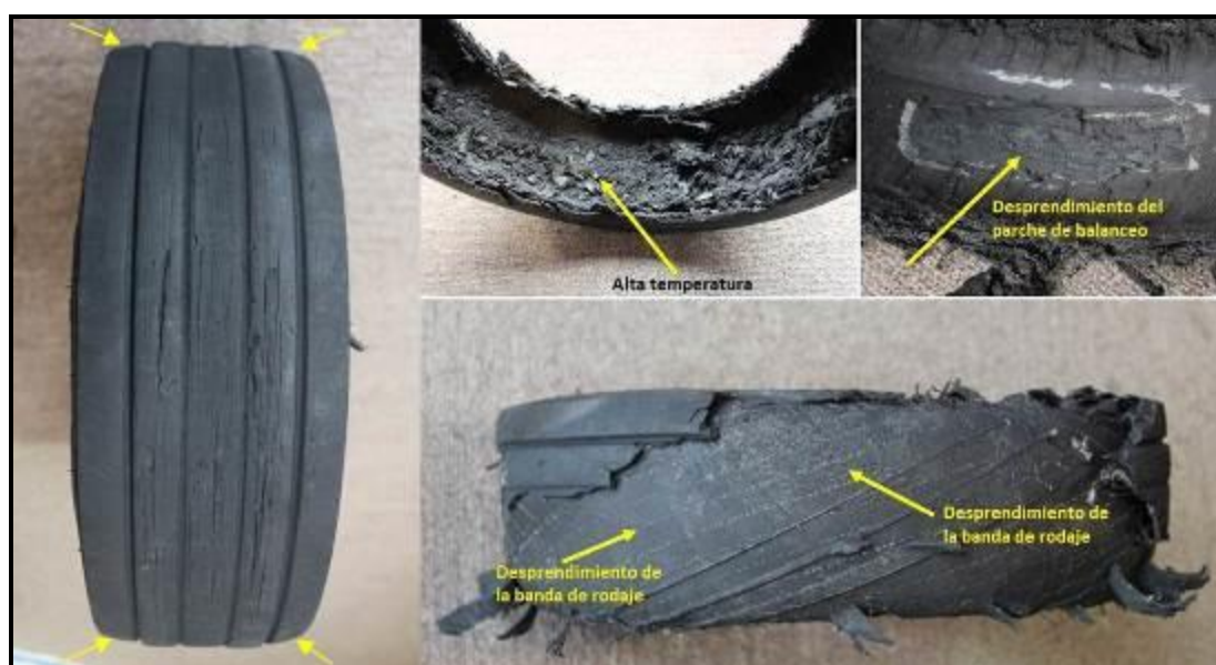
Figura 16. Desgaste y daños en las cubiertas
