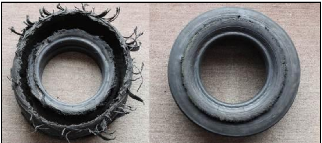
Figura 8. Daños en los neumáticos
