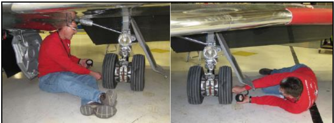
Figura 14. Medición de presión de neumáticos
