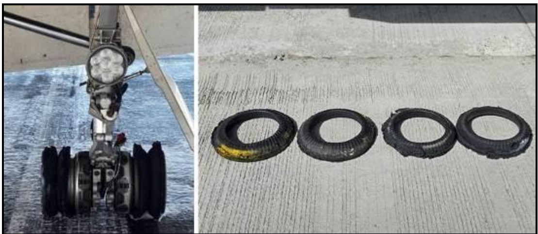
Figura 7. Daños en los neumáticos
