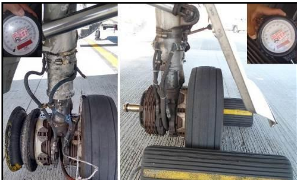
Figura 11. Medicion de presión de los neumaticos del tren principal derecho
