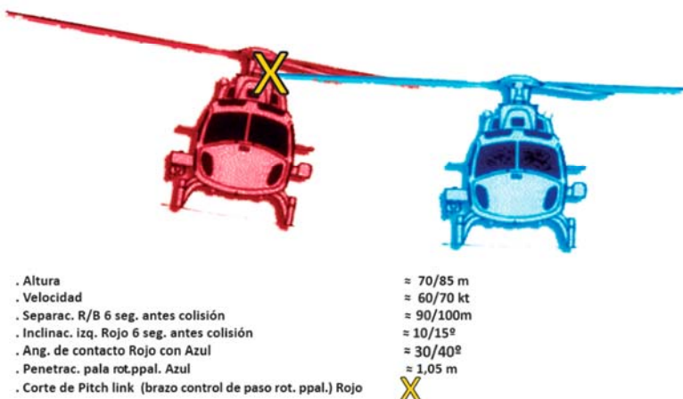
Figura 14. La colisión entre los helicópteros
