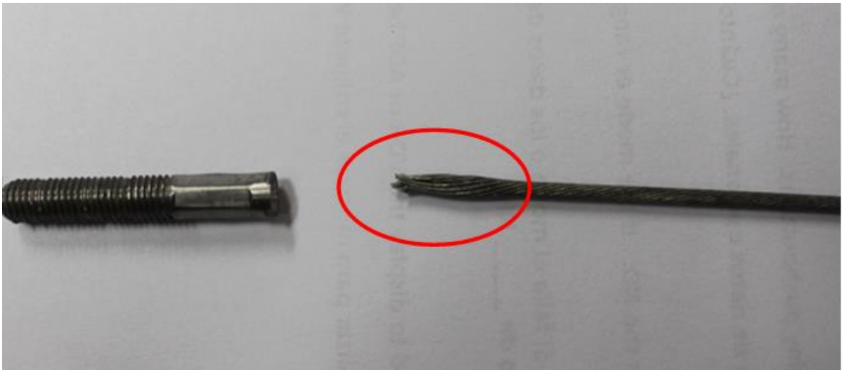
Figura 9. Disposición en la que quedaron los hilos del cable de acero luego del ensayo de tracción hasta su desprendimiento
