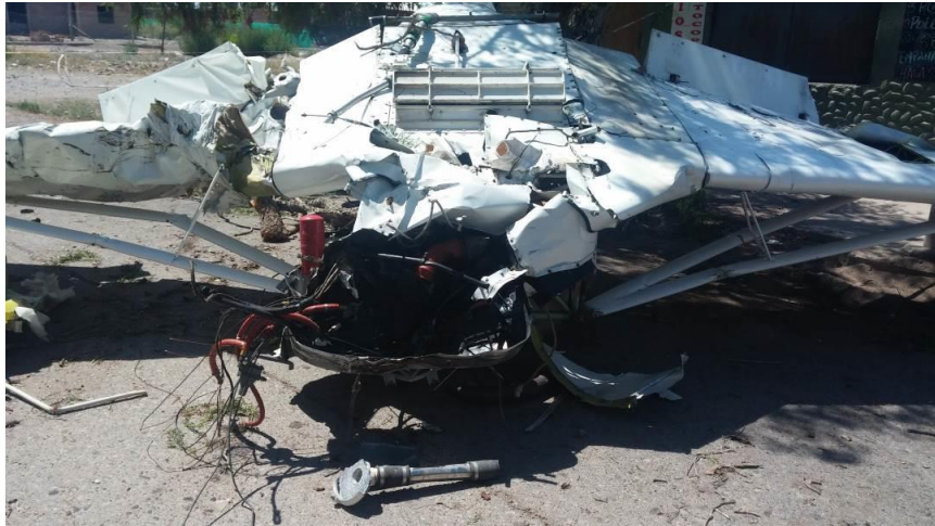
Figura 2. Se observa la ausencia del motor en su alojamiento
