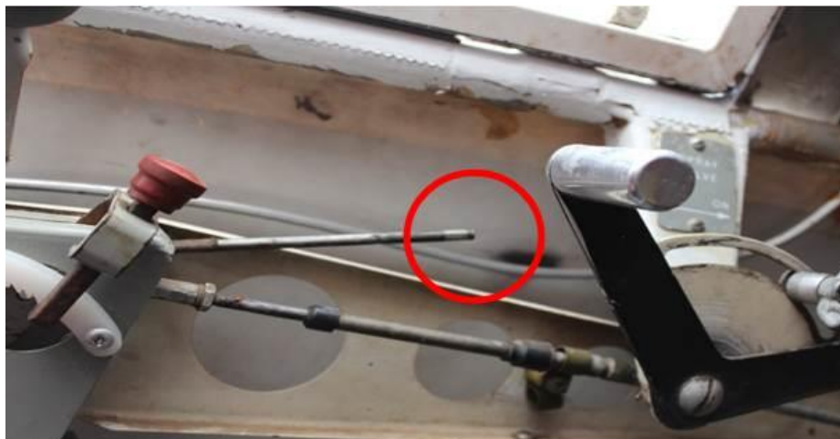
Figura 7. Casquillo solidario al movimiento de la palanca de potencia
