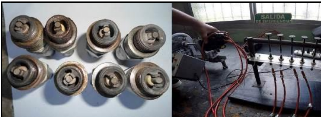
Figura 7. Estado de las bujías, prueba de los magnetos y de los cables de conexión
