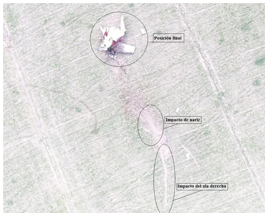
Figura 6. Marcas dejadas sobre el terreno
