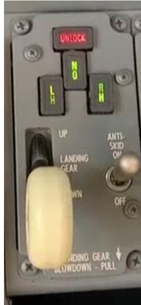
Figura 9. Visualización de luces durante test del sistema
