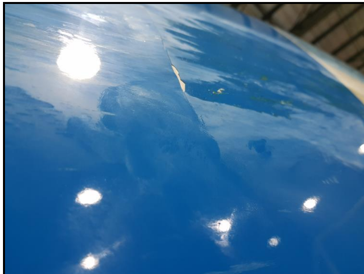
Figura 1. Imagen de los daños en el fuselaje
