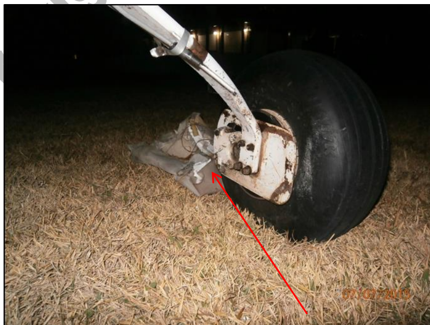
Fig. 6 - Tren de aterrizaje ppal. derecho del LV-GYV, con restos de entelado del ala del LV-FZV
