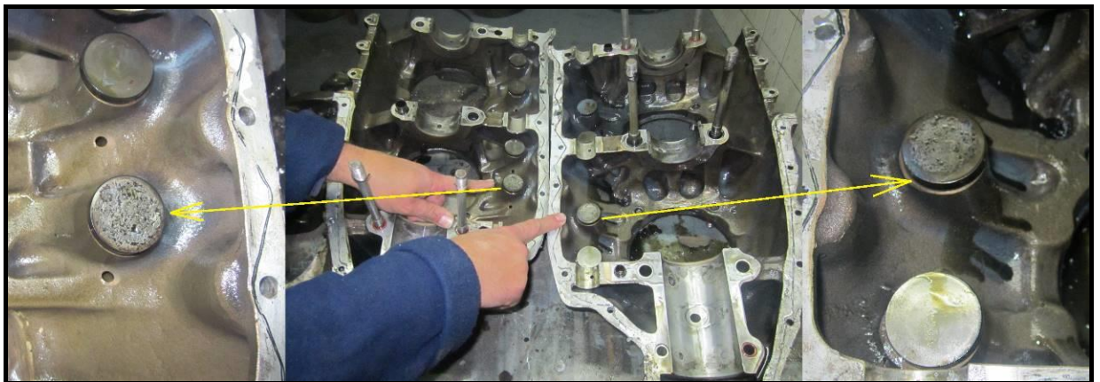
Fig 11: Desgaste sobre botadores de admisión de los cilindros N° 1 y N° 2.
