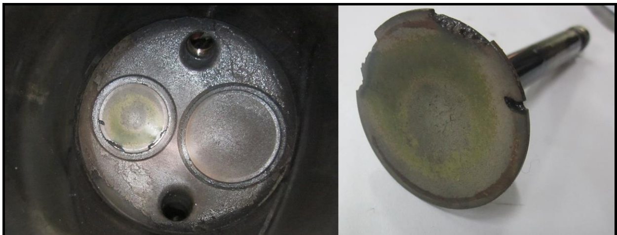
Fig 9: Daños en válvula de escape del cilindro N° 3.
