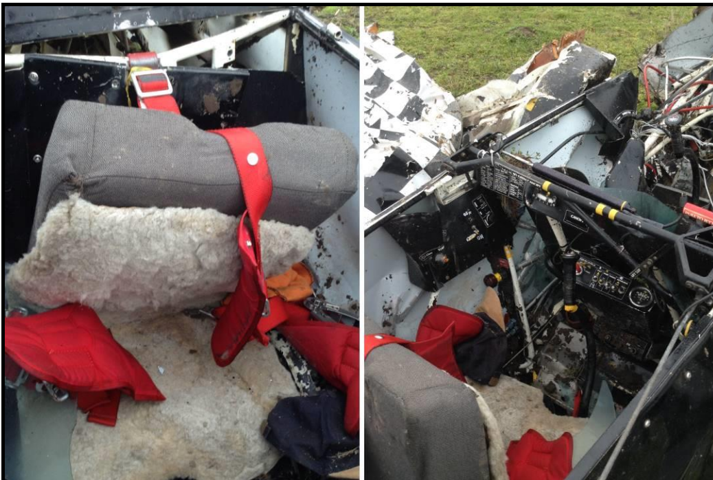
Fig 6: Habitáculo sin deformaciones.
