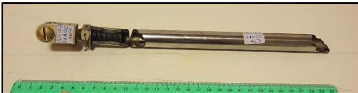
Figura 10. Vástago de actuador del tren de nariz.
