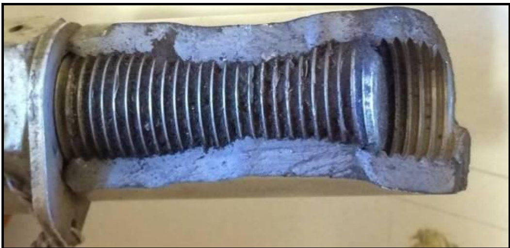
Figura 12. Superficie de fractura del vástago de actuador del tren de nariz. Se puede observar una fractura longitudinal coincidente con la parte roscada para su fijación
