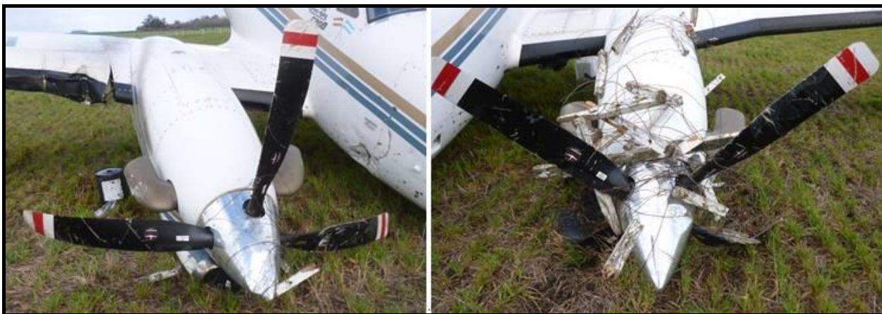
Figura 8. Daños en las palas
