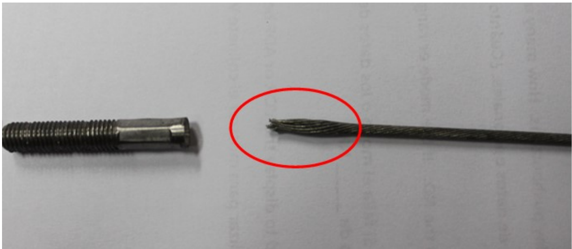
Figura 9. Disposición en la que quedaron los hilos del cable de acero luego del ensayo de tracción hasta su desprendimiento
