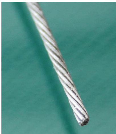
Figura 12. Cable de acero sin deformación plástica
