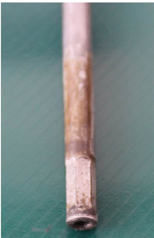
Figura 15. Casquillo fijo, zona de prensado
