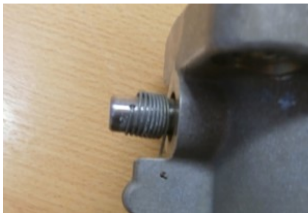
Figura 16: Imagen que nos muestra el resorte incorporado sobre el eje de la mariposa, en un carburador similar.
