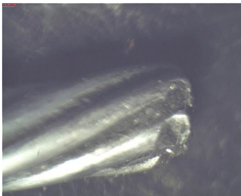
Figura 13. Cable de acero sin deformación plástica
