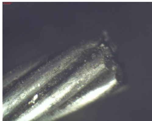
Figura 14. Cable de acero sin deformación plástica
