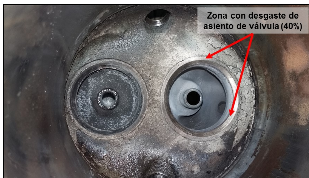
Figura 4. Estado del cilindro n° 1
