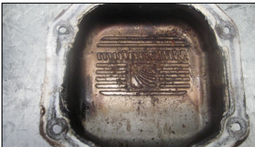
Figura 7. Estado de la tapa de balancines
