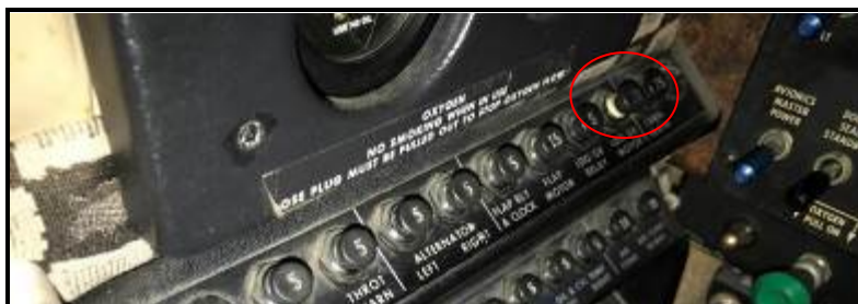
Figura 8. Panel de fusibles térmicos. Fusible de LDG GR Motor abierto
