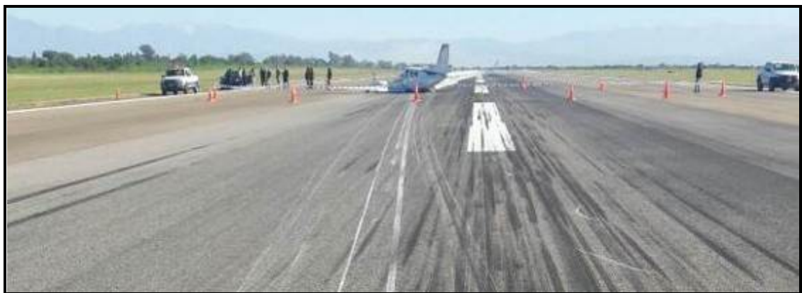
Figura 6. Imagen de la aeronave accidentada y marcas dejadas sobre la pista
