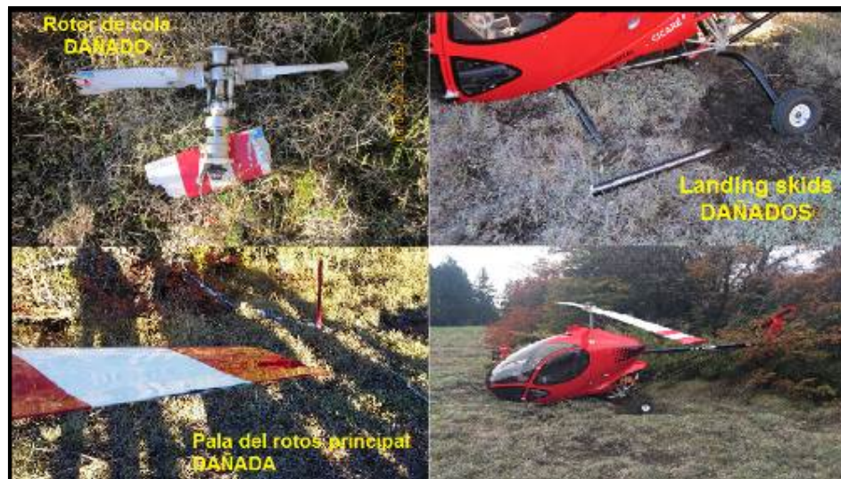
Figura 1. Vista de diferentes partes dañadas del helicóptero
