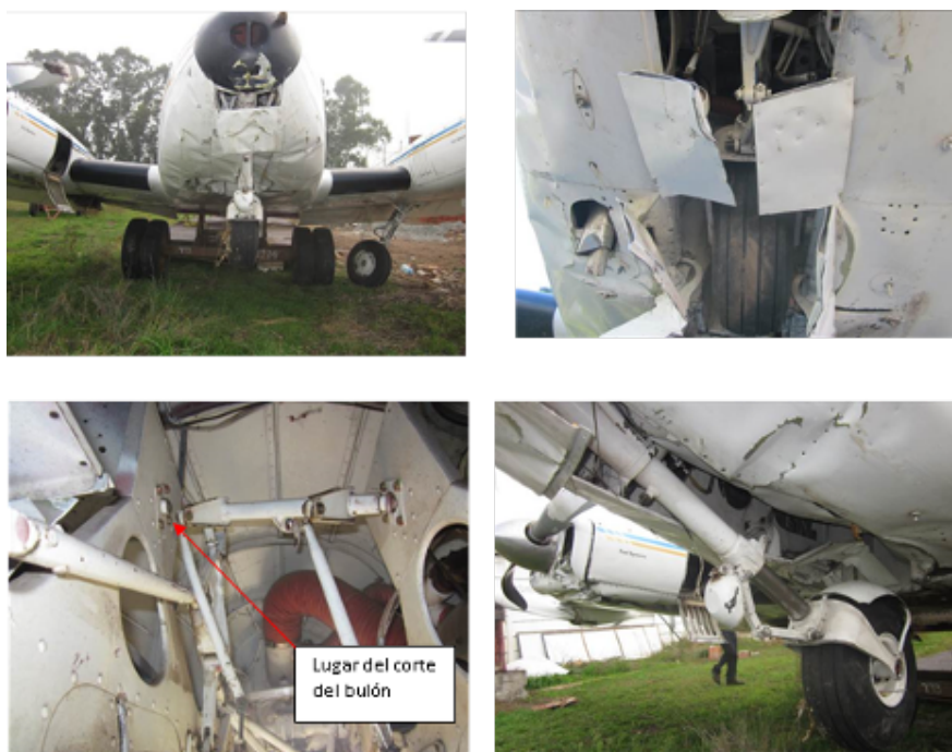
Figura 3. Vistas del conjunto del tren de nariz colapsado.
